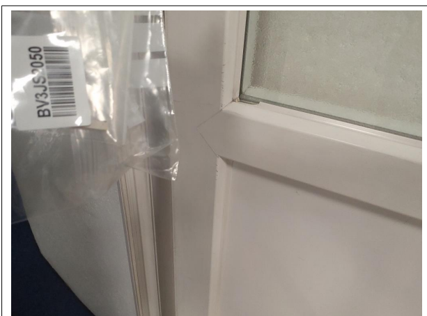
Prélèvement - P11 : RDC / Z1 - Accueil - Joint de vitrage- (Absence d'amiante)
