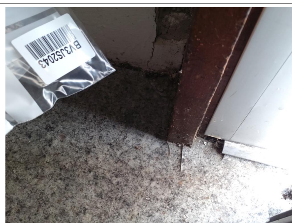
Prélèvement - P4 : RDC / Z11 - Bureaux - Colle- (Absence d'amiante)
