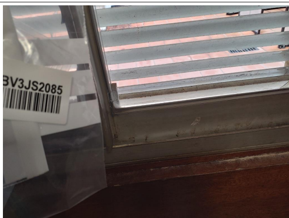
Prélèvement - P46 : RDC / Z4 - Archives - Joint de vitrage- (Absence d'amiante)
