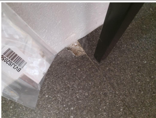
Prélèvement - P17 : RDC / Z3 - Bureau - Chape maigre- (Absence d'amiante)
