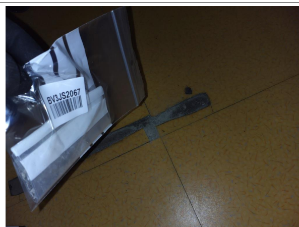
Prélèvement - P28 : RDC / Z8 - Guichet - Ragréage- (Absence d'amiante)
