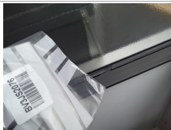
Prélèvement - P37 : RDC / Z6 - Bureaux - Joint de vitrage- (Absence d'amiante)
