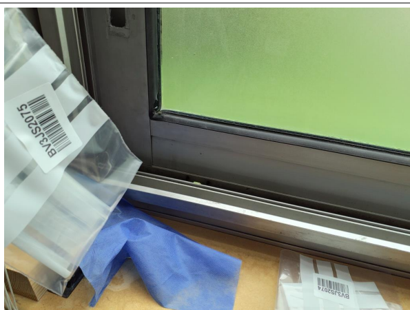
Prélèvement - P36 : RDC / Z6 - Bureaux - Joint de vitrage- (Absence d'amiante)
