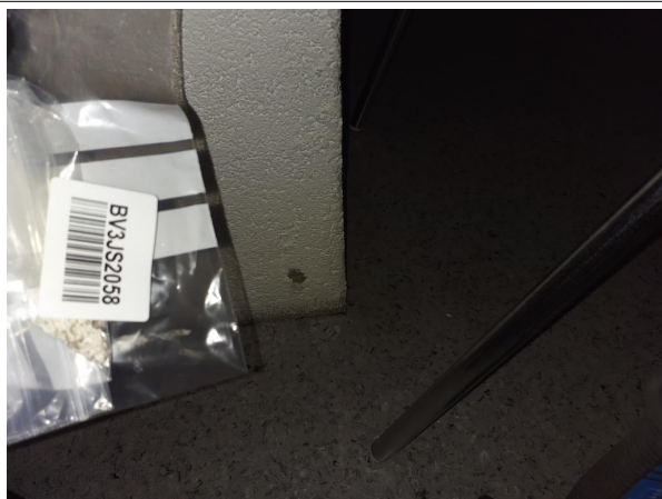
Prélèvement - P19 : RDC / Z1 - Accueil - Enduit- (Absence d'amiante)
