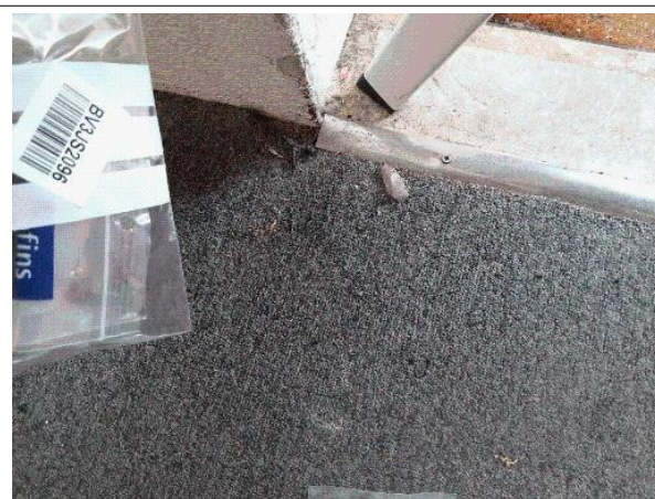
Prélèvement - P57 : RDC / Z12 - Dégagement - Dalle de sol- (Absence d'amiante)
