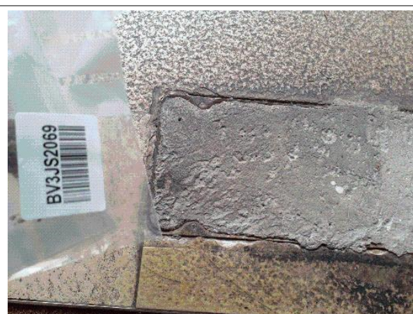
Prélèvement - P30 : RDC / Z7 - Bureaux - Chape maigre- (Absence d'amiante)
