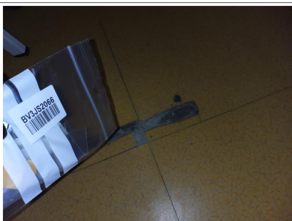
Prélèvement - P27 : RDC / Z8 - Guichet - Dalle de sol- (Absence d'amiante)
