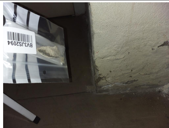
Prélèvement - P55 : RDC / Z9 - Archives - Enduit- (Absence d'amiante)
