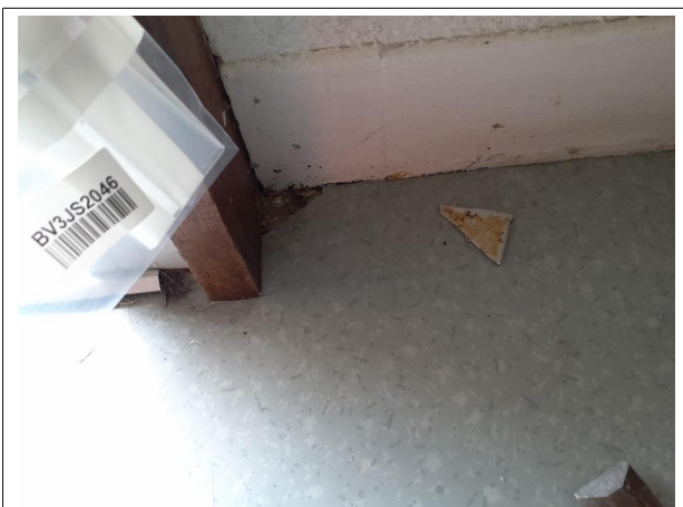
Prélèvement - P7 : RDC / Z11 - Bureaux - Colle- (Absence d'amiante)
