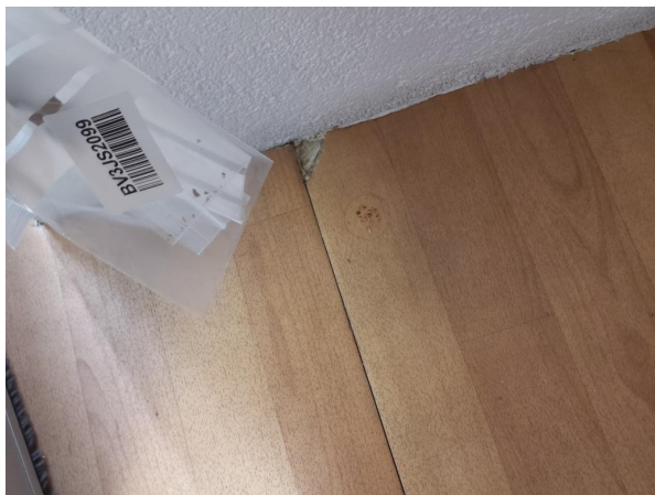
Prélèvement - P60 : RDC / Z10 - Bureau - Colle- (Absence d'amiante)
