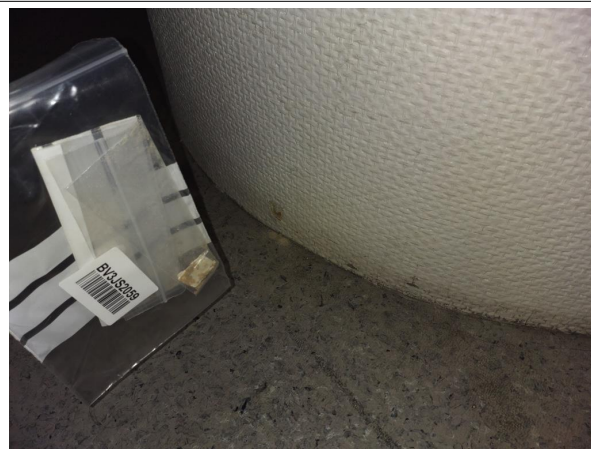
Prélèvement - P20 : RDC / Z1 - Accueil - Enduit- (Absence d'amiante)
