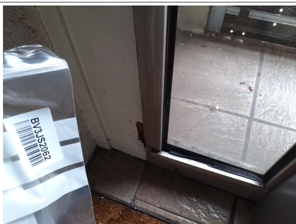
Prélèvement - P23 : RDC / Z1 - Accueil - Peinture- (Absence d'amiante)
