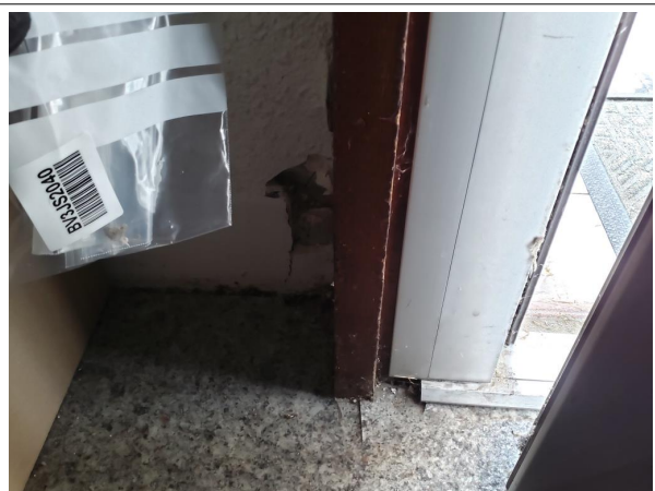
Prélèvement - P1 : RDC / Z11 - Bureaux - Colle- (Absence d'amiante)
