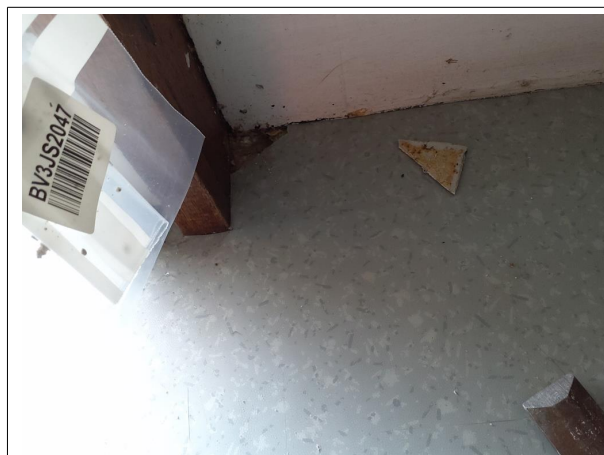
Prélèvement - P8 : RDC / Z11 - Bureaux - Chape maigre- (Absence d'amiante)
