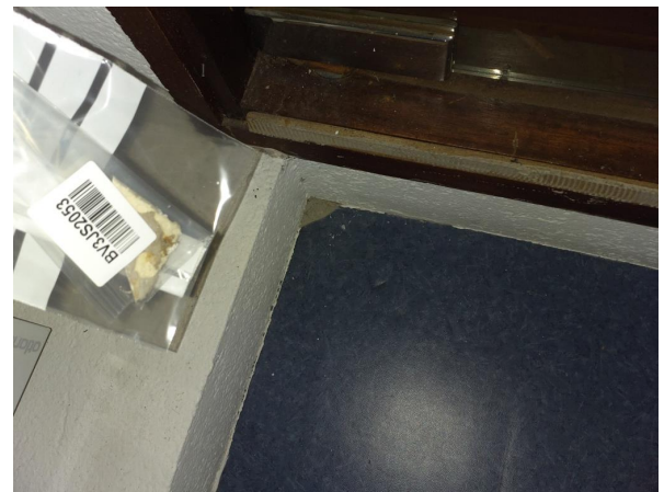
Prélèvement - P14 : RDC / Z2 - Bureau - Lé plastique- (Absence d'amiante)
