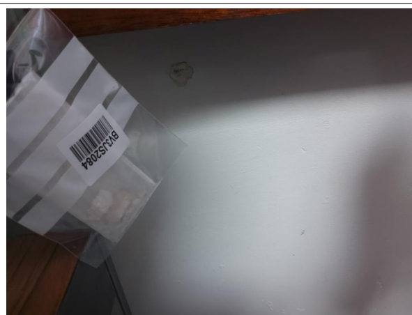
Prélèvement - P45 : RDC / Z4 - Archives - Enduit- (Absence d'amiante)
