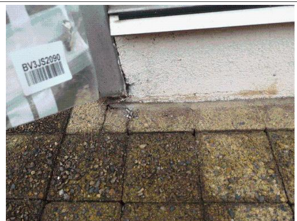
Prélèvement - P51 : Extérieur / Façade - Enduit- (Absence d'amiante)
