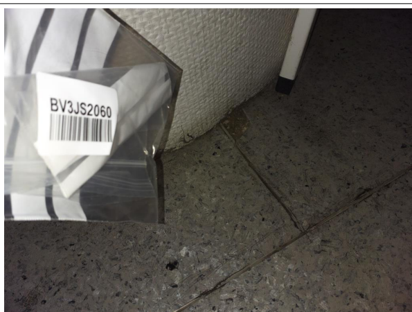
Prélèvement - P21 : RDC / Z1 - Accueil - Chape maigre- (Absence d'amiante)
